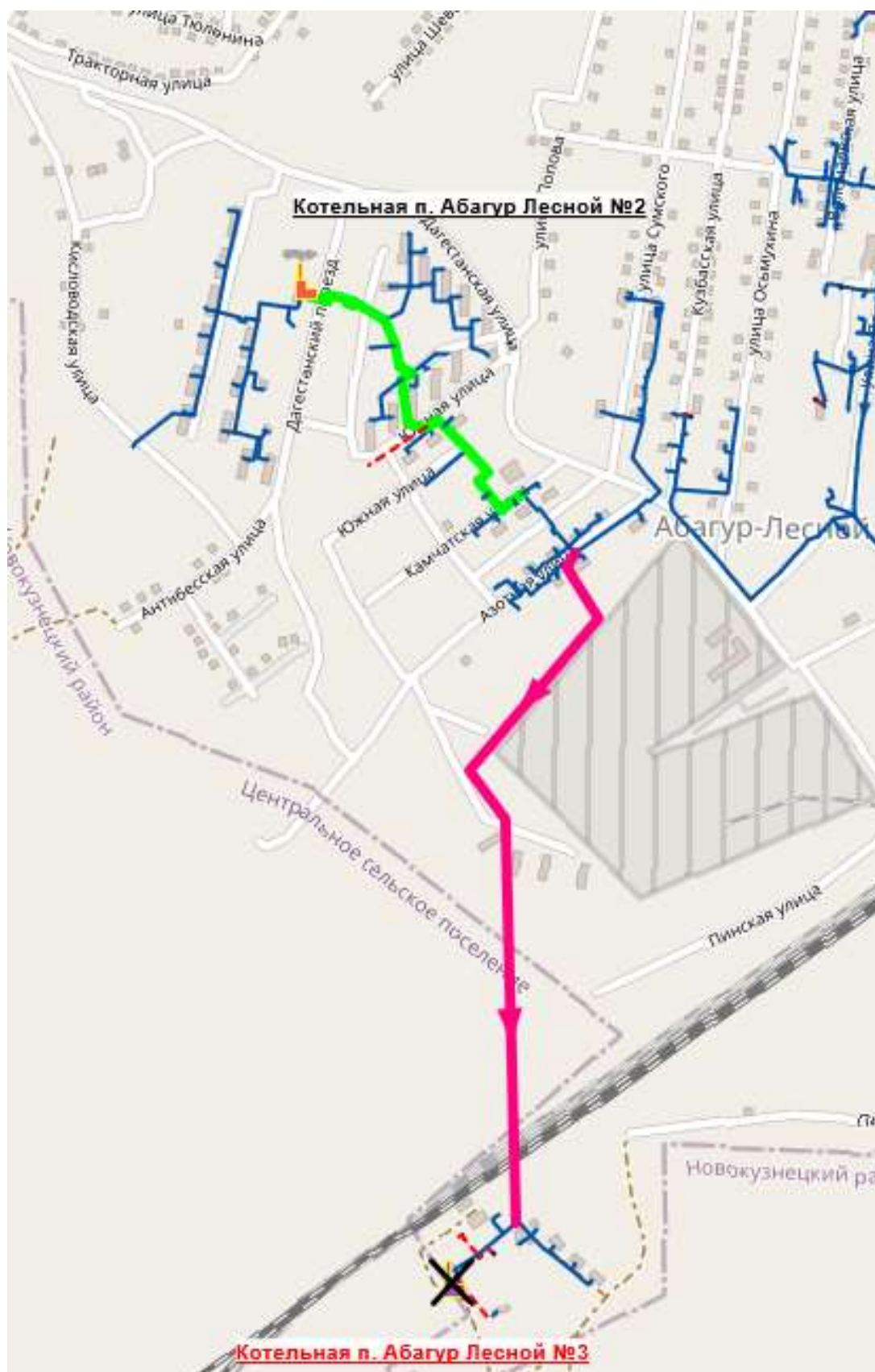
Рисунок 6.13 – Строительство тепловых сетей для переключения котельной №3 п. Абагур-Лесной на котельную №2 п. Абагур-Лесной
